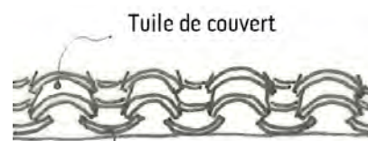
Mise en oeuvre traditionnelle de la pose des couvertures en tuile canal
