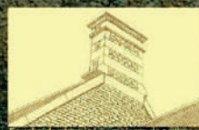
Souche de cheminée en pierre de taille
