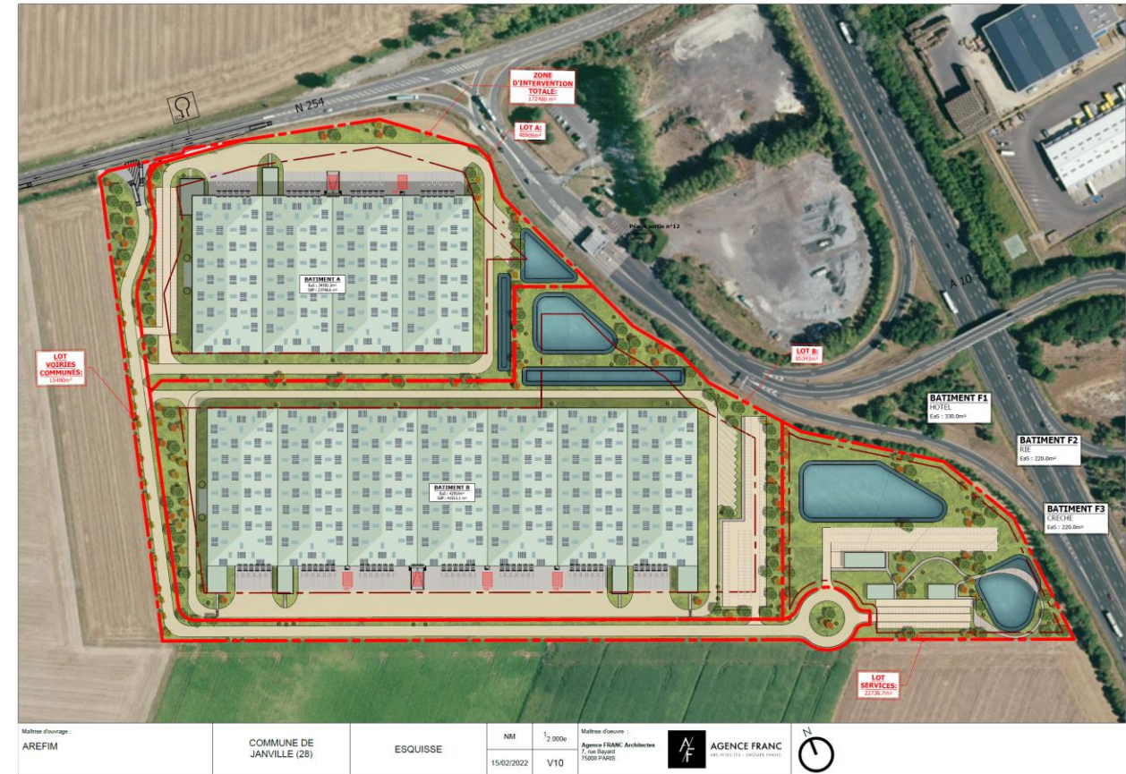
Plan de masse toiture du site
