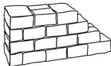
Appareillage réglé, à assises régulières.
