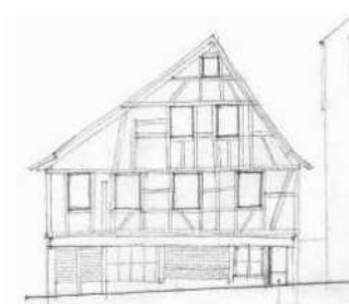
MAISON DE BOURG AVEC PIGNON SUR RUE ET SCHLUPF
