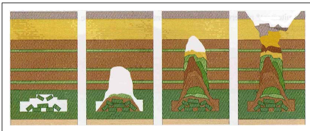
Figure 53 - Schéma de principe d'évolution d'un effondrement localisé (d'après Évaluation des Aléas liés aux Cavités Souterraines - LCPC - 2002).
