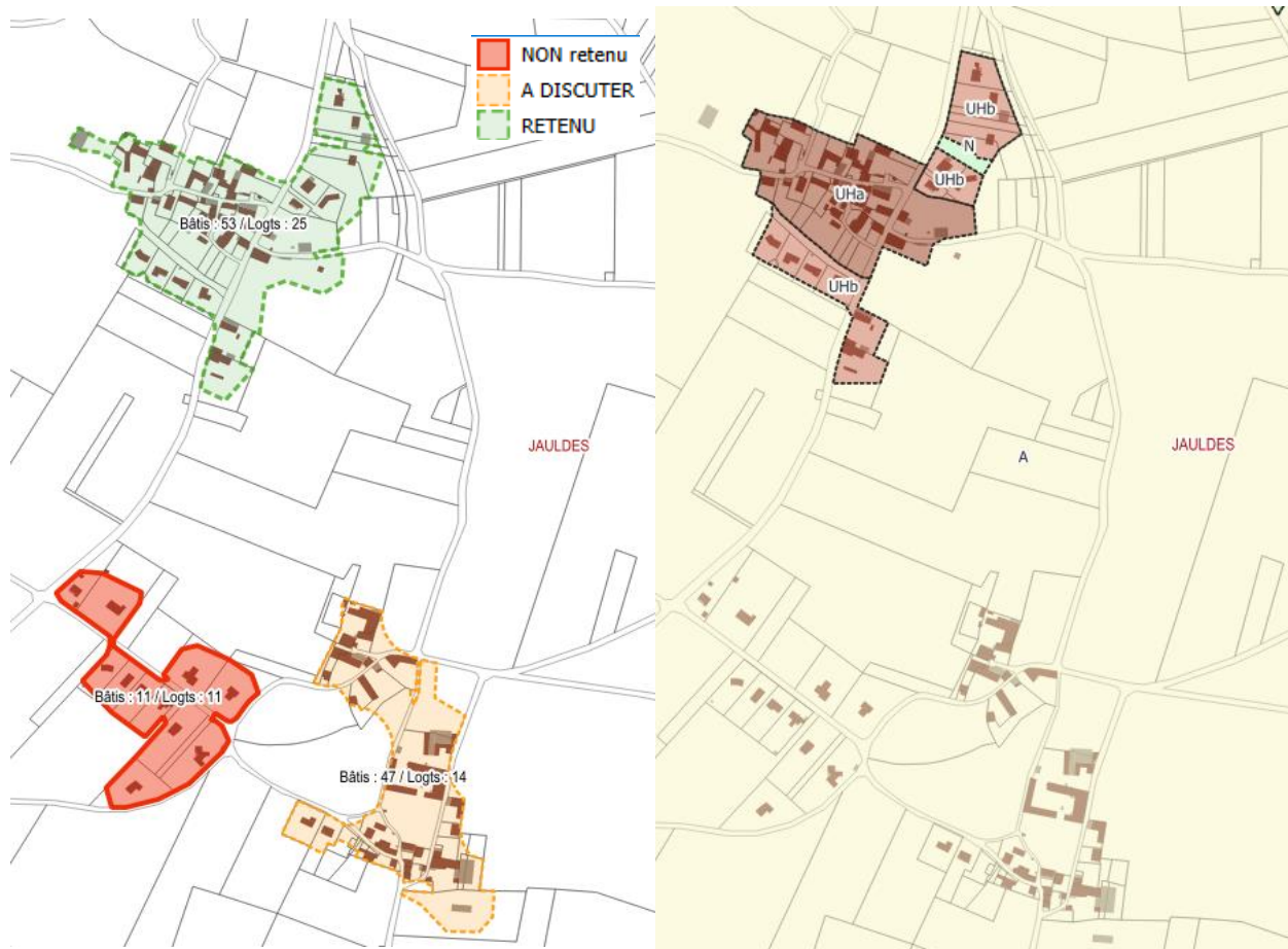
Exemple de mise en forme et d'analyse des enveloppes urbaines, avec zonage résultant au regard des critères retenus
