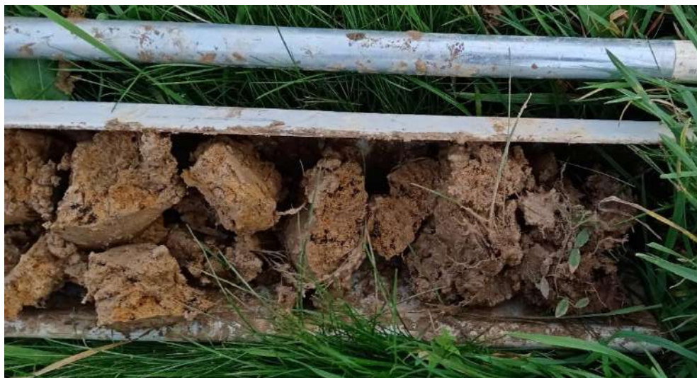
Exemple d'un sondage de sol rédoxique, pseudogley à 15 cm, classe GEPPA Vc = sondage caractéristique de zone humide
