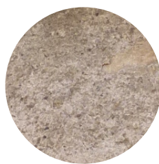
Enduit à la chaux naturelle
