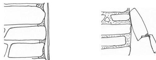
Les enduits traditionnels présentent plusieurs couches : un corps d'enduit et une finition mince. Dans le cas des enduits à pierres vues, racler d'une pierre à l'autre avec le plat de la truelle, sans creuser.
