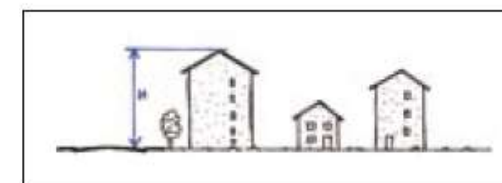
Bâtiment-écran protégeant les autres constructions
