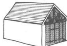
Pignon charpenté vitré
