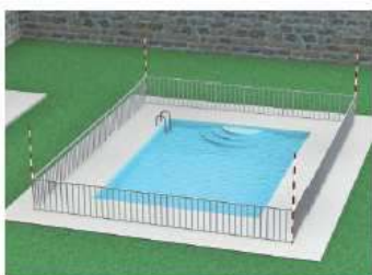
Piscine privée équipée d'une barrière de sécurité
