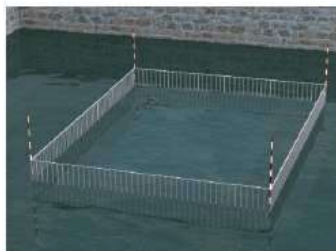
La barrière de sécurité reste visible tant que le niveau d'eau est inférieur à sa hauteur
