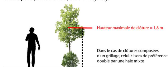
Clôture principalement composée d'un grillage
