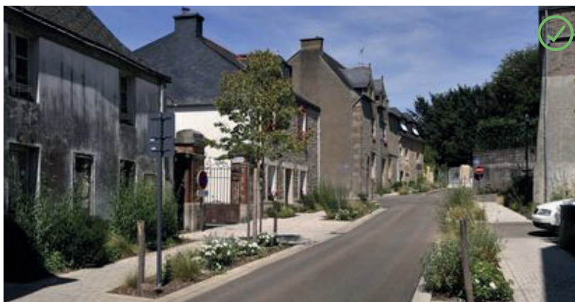
Exemple de bord de route paysager qui permet de valoriser le cheminement piéton, désimperméabilise le sol et rend plus conviviale la rue
