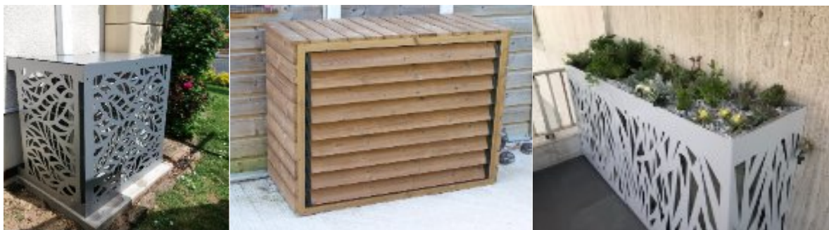
Exemple de dispositifs d'occultation pour des dispositifs de génie climatique
