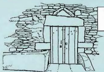
triangle de décharge et linteau monilithe en pierre
