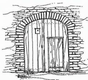
Pierres posées de chant pour former un arc en anse de panier
