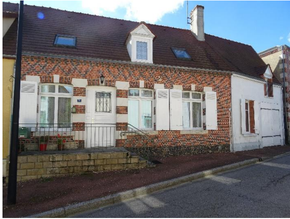
Façade en pierres calcaires, façade en briques, colombage
