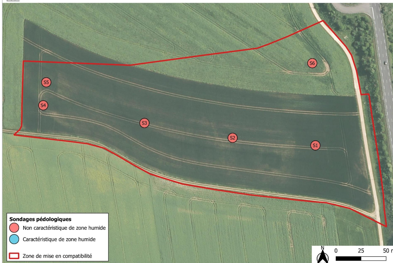
Figure 11 : Localisation des sondages géologiques réalisés pour l'étude du caractère humide du site - Source : IAD
