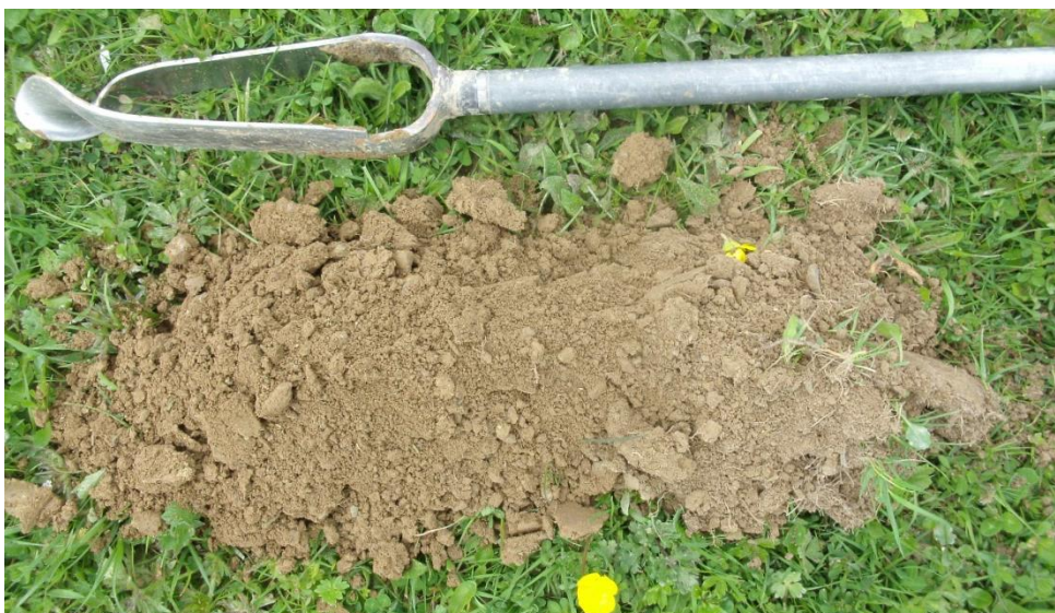
Sondage S56 : Limon marron, sans trace d'hydromorphie, sol peu profond
