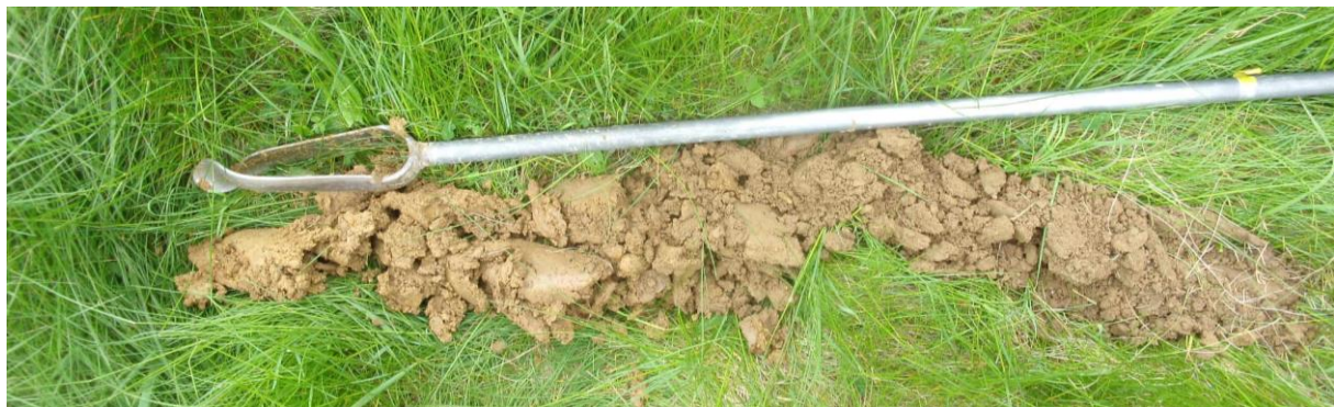
Sondage S39 : Limon marron profond, sans trace d'hydromorphie, avec des cailloutis de schiste en fond de tarière
