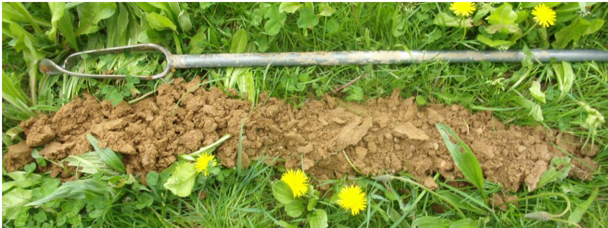
Limon de couleur homogène : sol sain, sans trace d'hydromorphie (sondage n°1)
