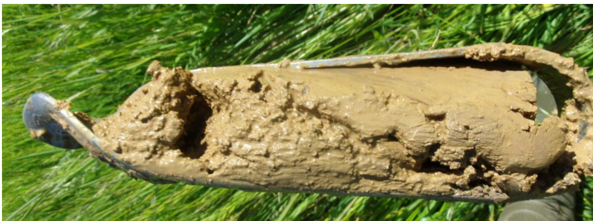
Sondage S64 : eau présente à partir de 60 cm de profondeur
