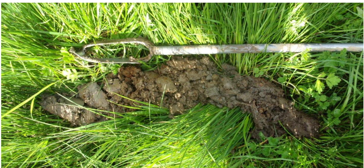
Sondage S1 présentant une couleur grisâtre et de nombreuses tâches ocres, caractérisant un sol hydromorphe
