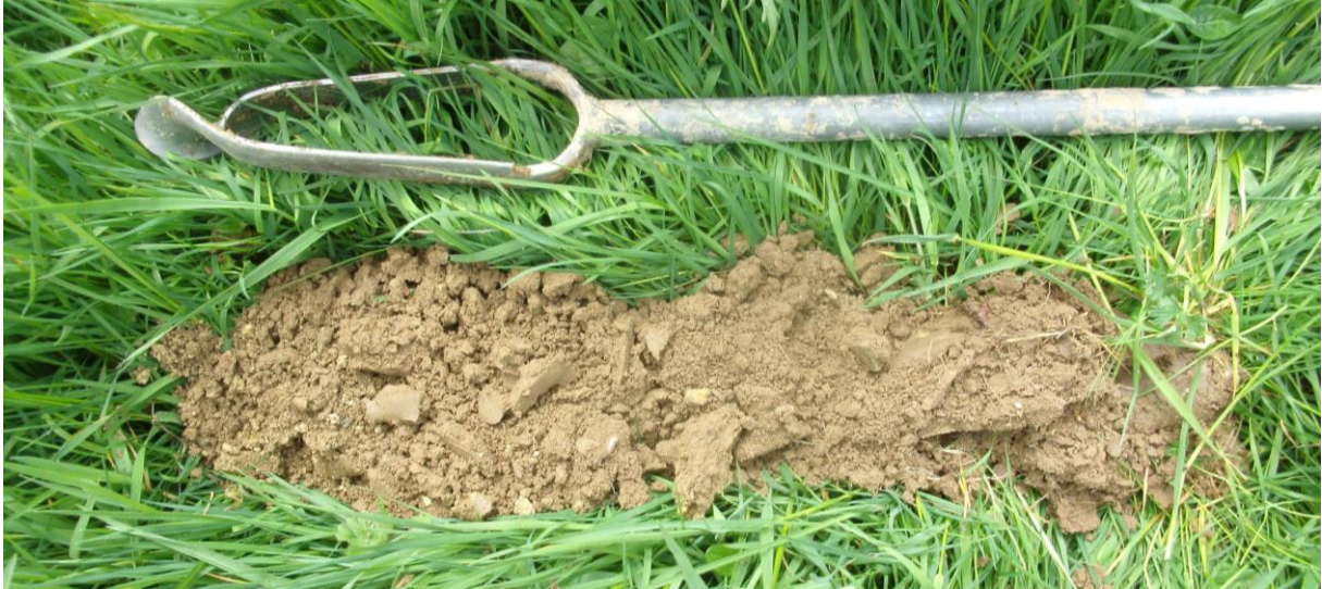
Sondage S16 présentant un limon de couleur homogène : sol sain, sans trace d'hydromorphie
