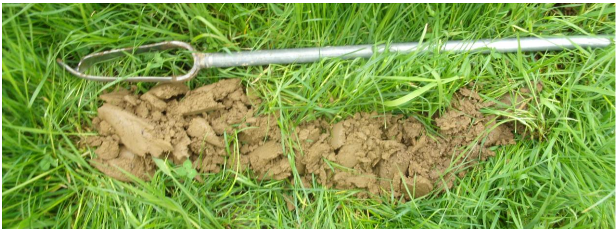
Sondage S54 : Limon marron de couleur homogène sans trace d'hydromorphie
