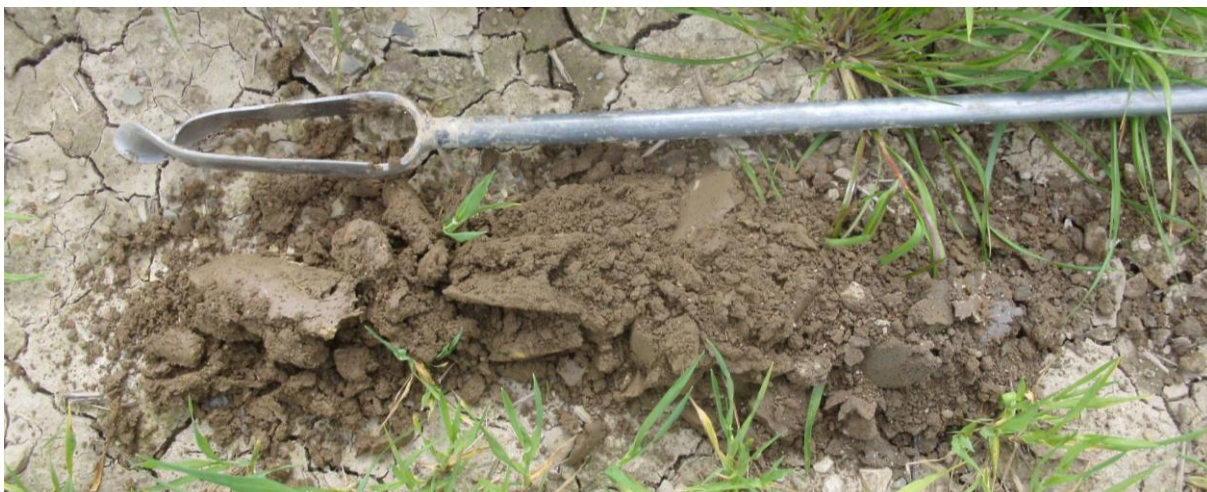
Sondage S22 : Limon de couleur marron homogène, sans trace d'hydromorphie
