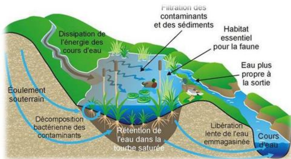
Schéma du fonctionnement d'une zone humide
