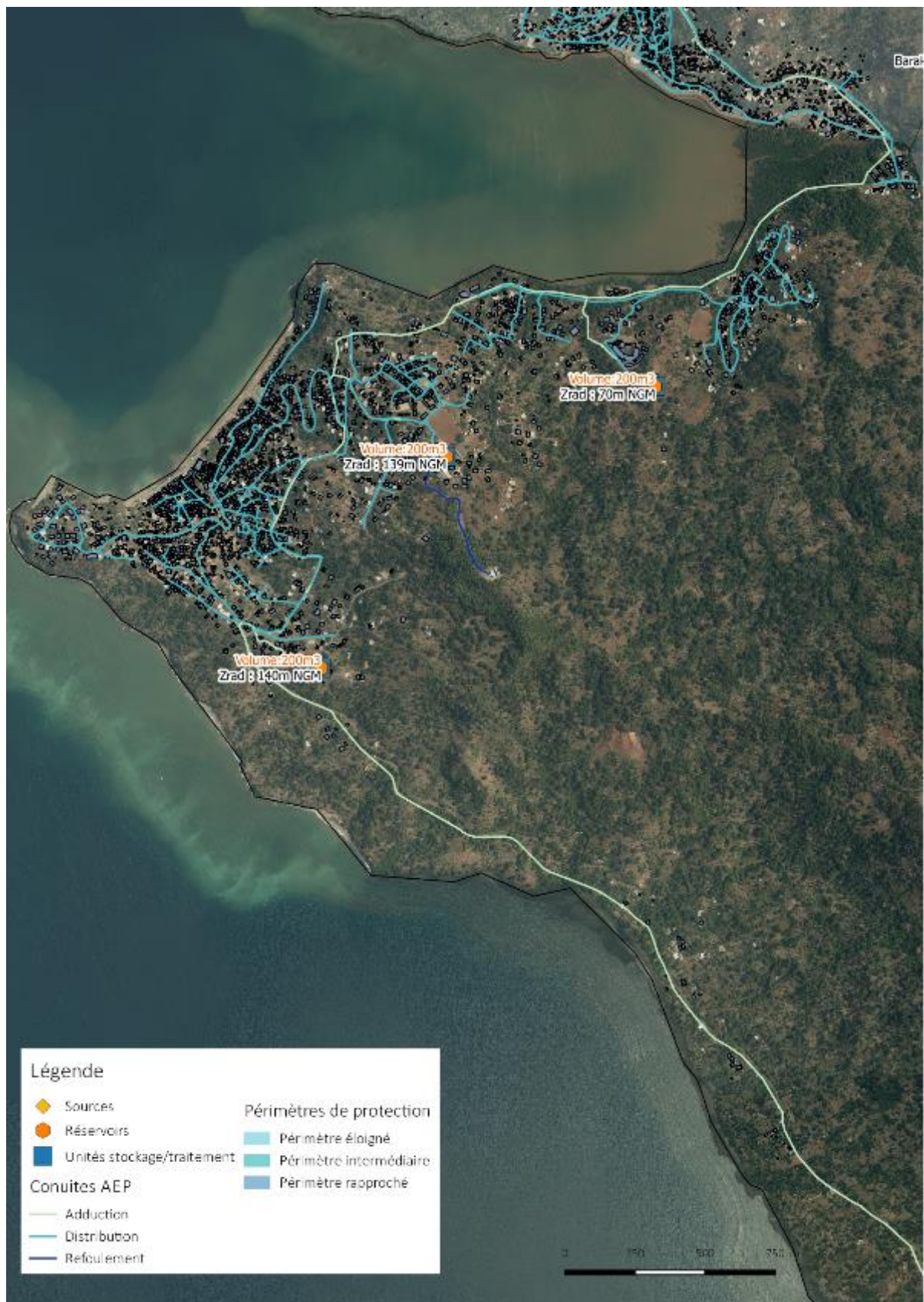
Figure 7 : Réseaux d'eau potable - Sada
