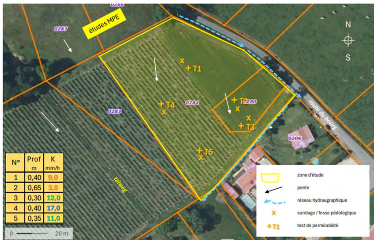
Figure 17 : Localisation des sondages et résultats des tests de perméabilité sur les parcelles n°280 et n°284, section ZA.
