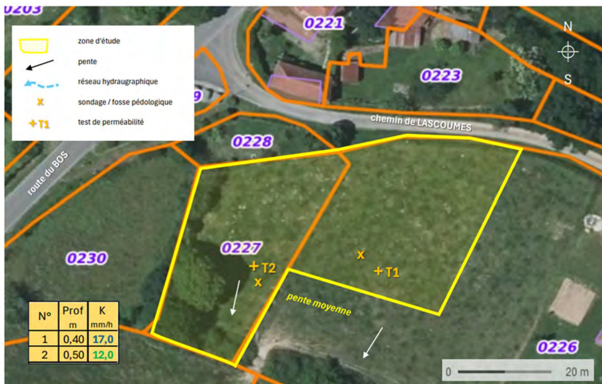
Figure 22 : Localisation des sondages et résultats des tests de perméabilité sur les parcelles n°226 et n°227 section B
