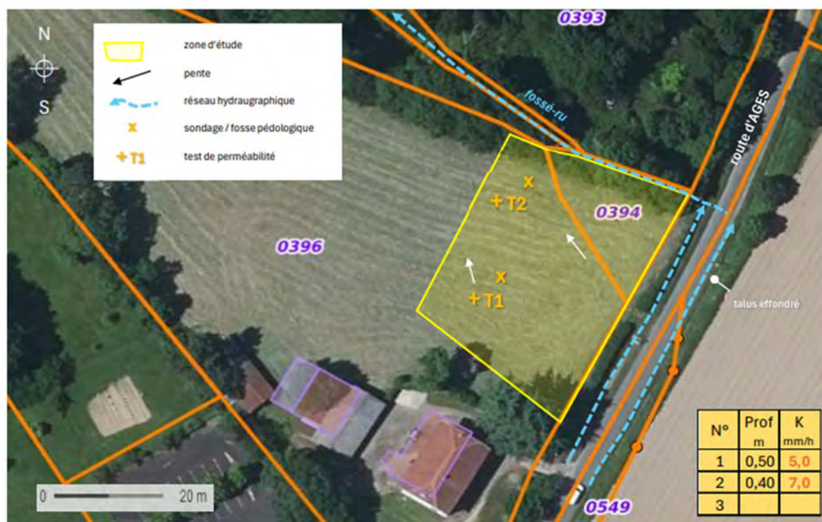
Figure 14 : Localisation des sondages et résultats des tests de perméabilité sur les parcelles n°394 et n°396 section A
