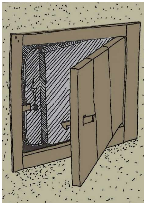
Le compteur peut être occulté par l'installation d'un volet en bois plein dans la façade de la construction (ou de la clôture maçonnée).
