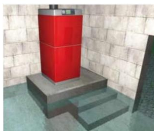
Mise hors d'eau par surélévation
