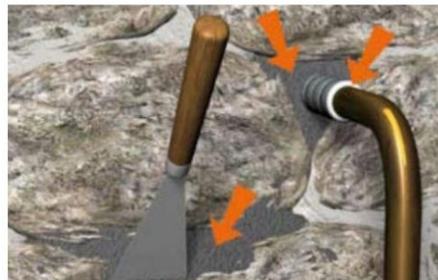
Situation après travaux de colmatage
