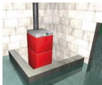
protection par disposition étanche
