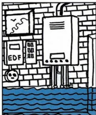
Rehausse des installations et matériels sensibles
