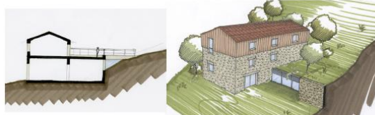
Exemple de volume annexe mitoyen et en jonction avec le terrain naturel
