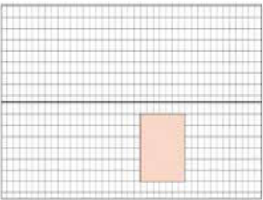
S'intégrer dans le plan et la pente de la toiture et s'aligner sur les axes des châssis existants
