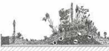
Coupe transversale d'un toit végétalisé, conçu pour valoriser la flore et la faune sauvages. Notez les nombreux types de profondeurs de substrats utilisés.
