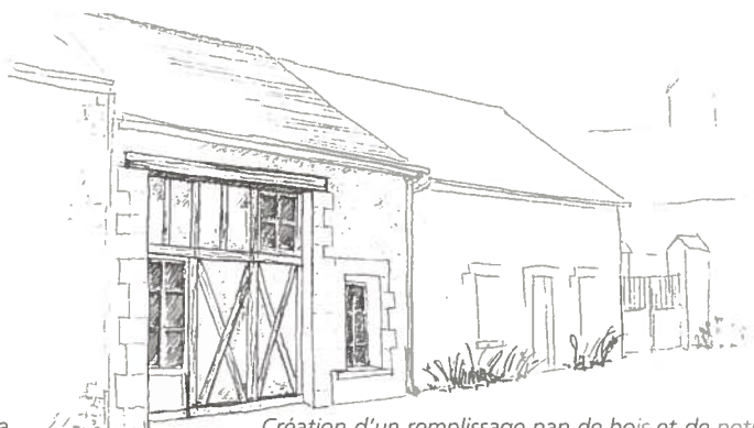
Création d'un remplissage pan de bois et de petites ouvertures, en conservant le dessin de la baie d'origine.
