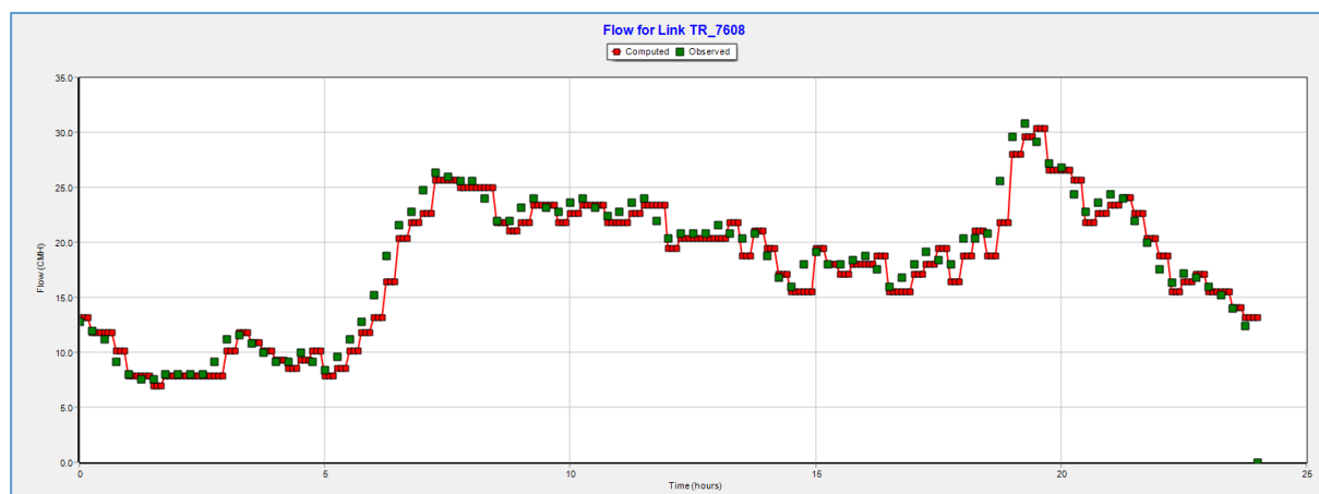
Figure 8 : Exemple de calage d'un débitmètre
