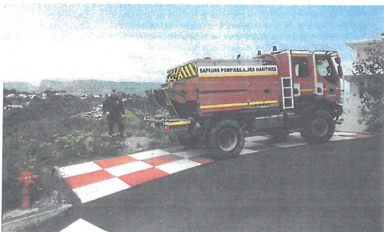
Aire de croisement pompiers et point d'eau incendie normalisé (Féric-Nord)
