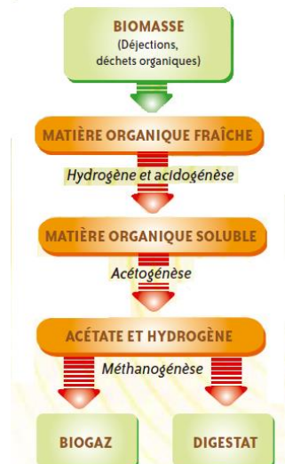
Figure 1 : Réactions du processus de méthanisation
