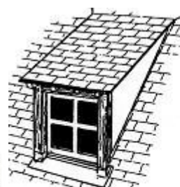
lucarne rampante ou en chien couché
