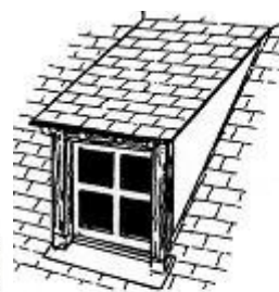
lucarne rampante ou en chien couché
