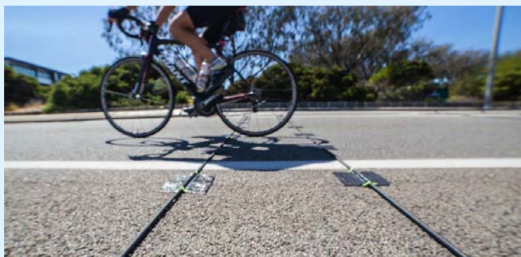
Dispositif de comptage des vélos (source : MetroCount)
